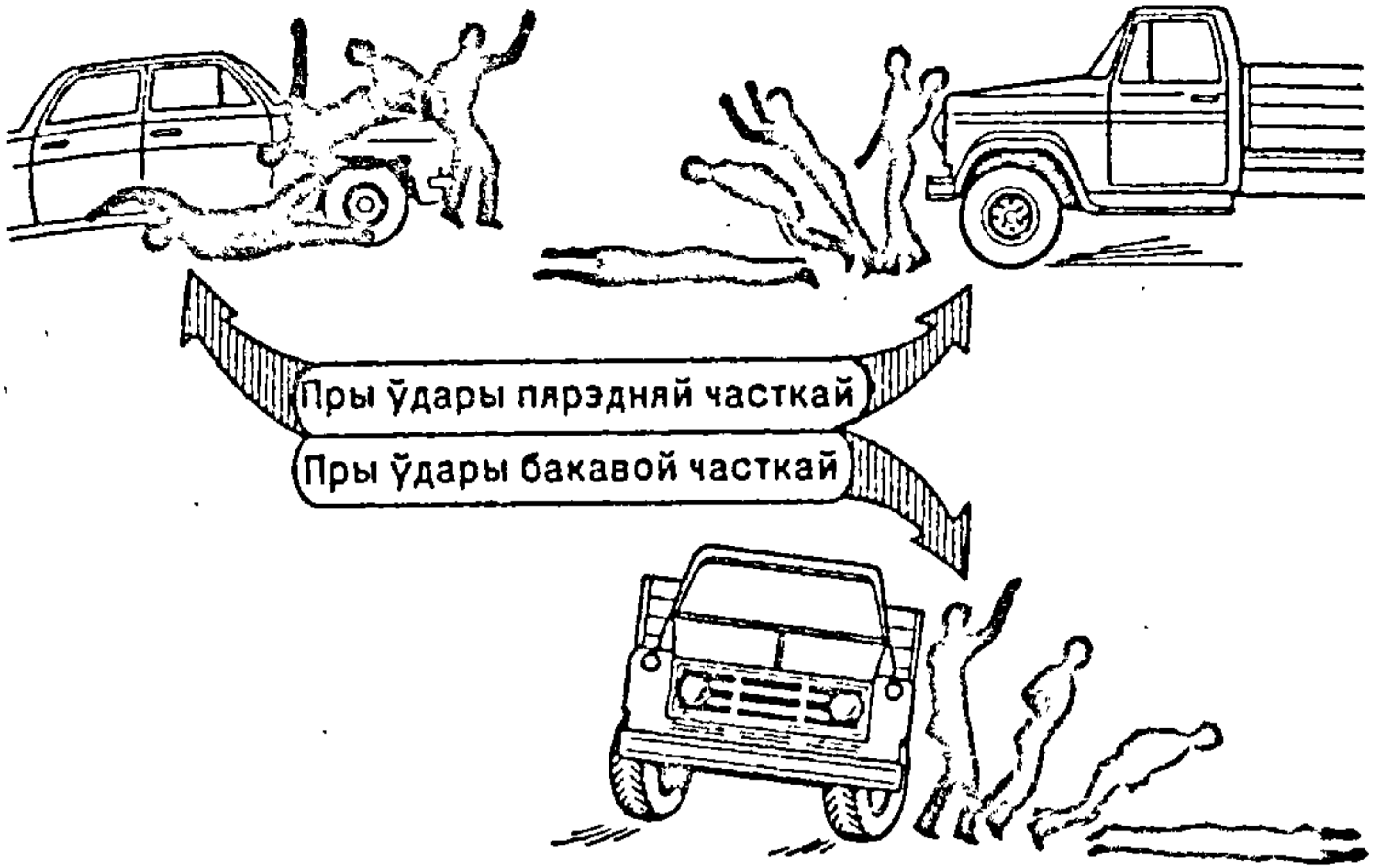
Мал. 37. Напрамак падзення цела чалавека ў залежнасці ад удару рознымі часткамі аўтамабіля, які рухаецца
