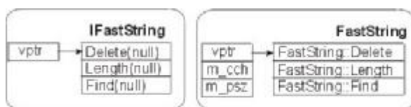
Рис. 1.7. FastString, использующий абстрактные базисы в качестве интерфейсов
